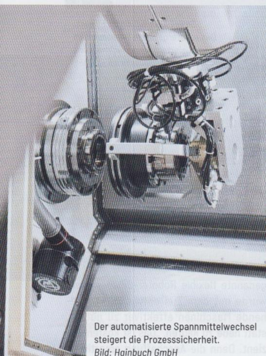
Der automatisierte Spannmittelwechsel steigert die Prozesssicherheit. Bild: Hainbuch GmbH
