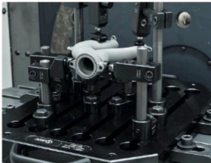
Der neue Baukasten von AMF enthält modulare Spannmittel für das Freiformspannen und überzeugt in allen Belangen für das Spannen von kleinen und mittleren Serien frei geformter Werkstücke.
