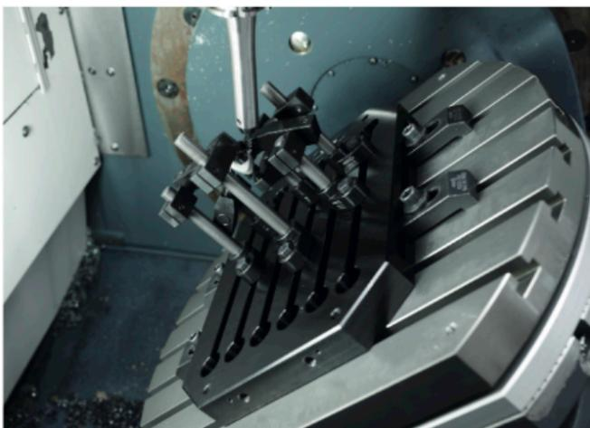
Durch die unendlichen Kombinationsmöglichkeiten lassen sich alle nur denkbaren Formen von Gussteilen, additiv hergestellten Teilen oder Kunststoffteilen für die Weiter- oder Endbearbeitung auf einem 5-Achs-Bearbeitungszentrum spannen.
