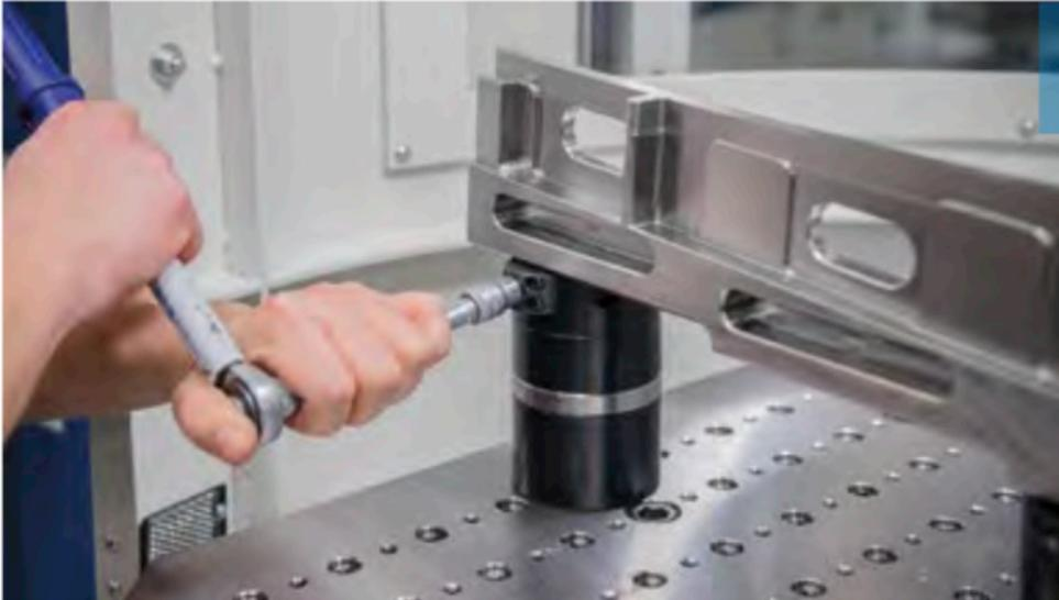
Rüstzeiten mit AMF Nullpunktspanntechnik minimieren: Mit wenigen Handgriffen ist das Werkstück gespannt.
