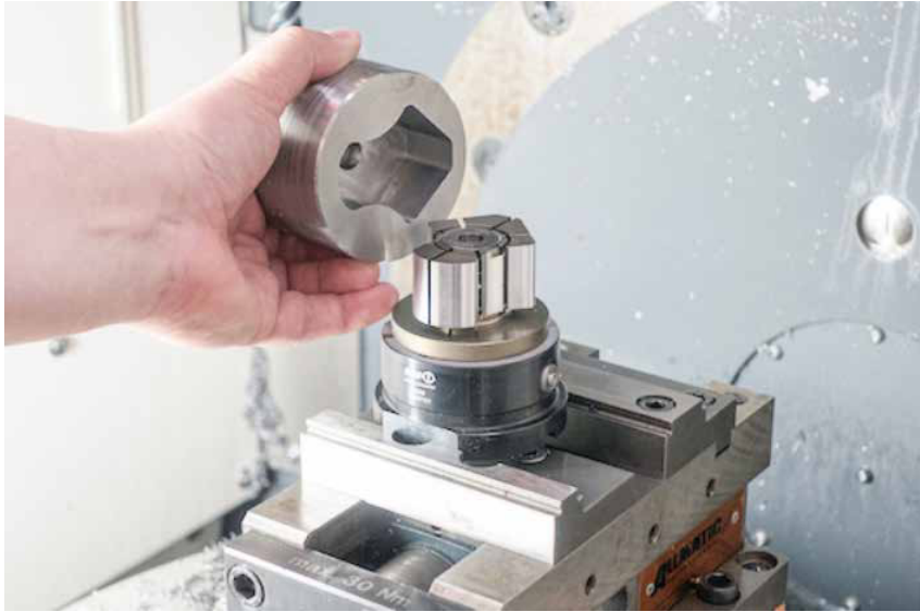
AMF zeigt auf der AMB eine neue Spannzange für das Innenspannen. Diese können Anwender an die Innenkontur ihrer Werkstücke anpassen.
