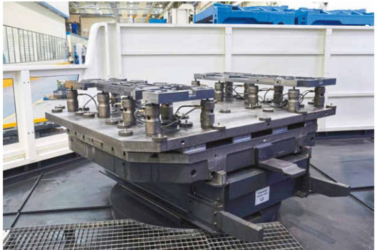
*Flexible Aufspannvorrichtungen als Basis für vier Varianten sehr großer Maschinenteile, die paarweise aufgespannt und bearbeitet werden. Für die Fixierung in erster und zweiter Aufspannung sorgt eine Kombination aus hydraulischen Niederzugspannern und anschwimmenden Unterstützungselementen. Bild: AMF*
