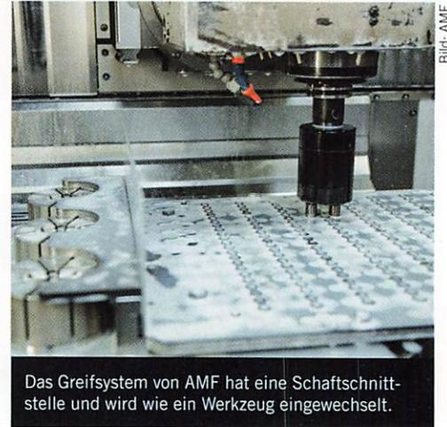
Das Greifsystem von AMF hat eine Schaftschnittstelle und wird wie ein Werkzeug eingewechselt.
