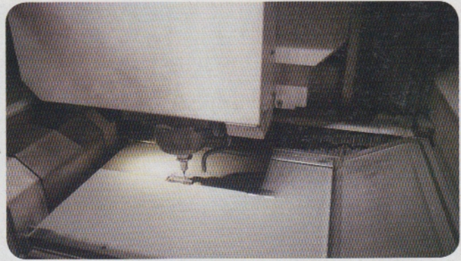
Der Fräskopf: Dessen Hochleistungsspindel beschleunigt den Fräser auf bis 45.000 U/min.
