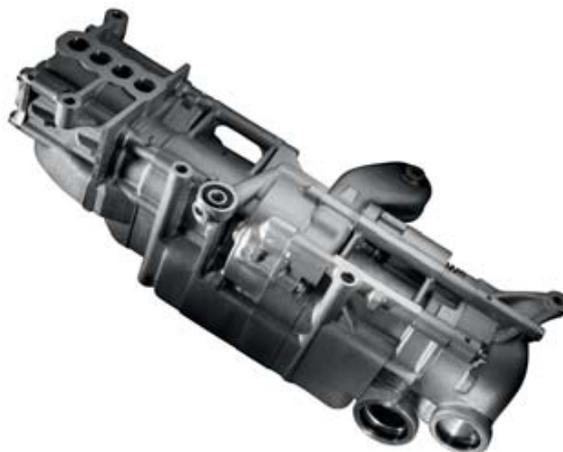
Gespannt werden die Rohteile in der AMF-Vorrichtung hydraulisch mit maximal 190 bar Druck.
