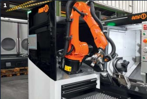
1 Smart Automation: Die schlanke Beladezelle von AMF mit nur wenig Platzbedarf wird an Maschinen beigestellt und schafft mehr Produktivität bis hin zu einer mannlosen Schicht.
