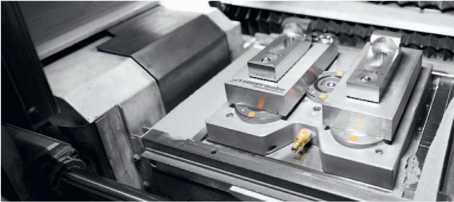
Mit dem Nullpunktspannsystem Zero-Point von AMF lassen sich Rüstzeiten um bis zu 90 Prozent reduzieren.
