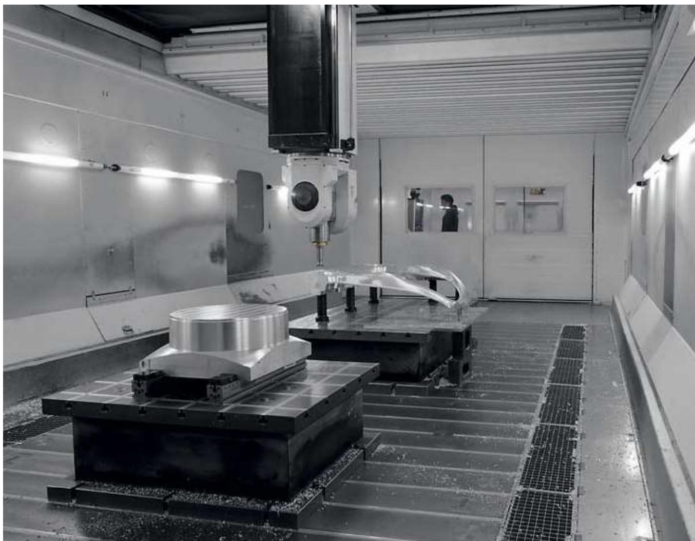
Die riesigen Aluminiumblöcke für die Einzelteile eines Alu-Modells im Maßstab 1:1 wie Bodengruppe, Seitenteile, Dach, Heckklappe und Räder müssen präzise auf den riesigen Portalfräsmaschinen gefertigt und vorher exakt gespannt werden.
