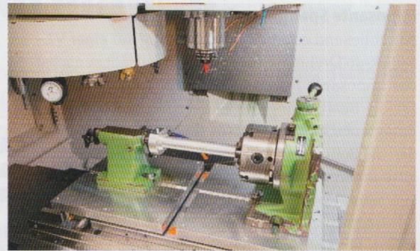
Zwei Adapterplatten von AMF enthalten Vorrichtungen, die sogar Drehoperationen auf der Maschine bei Labom ermöglichen.
