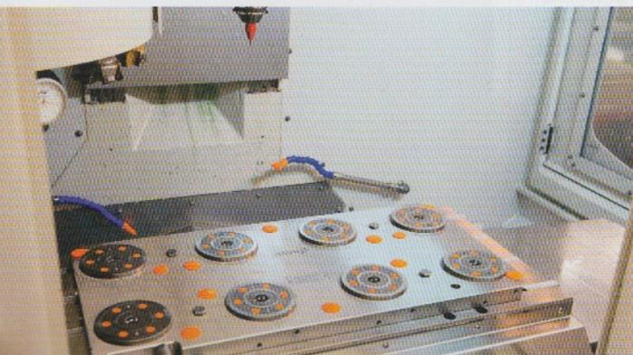
Die Spannstation von AMF mit acht eingebauten Nullpunktspannmodulen ist mit nur 36 mm Gesamthöhe extrem flach.
