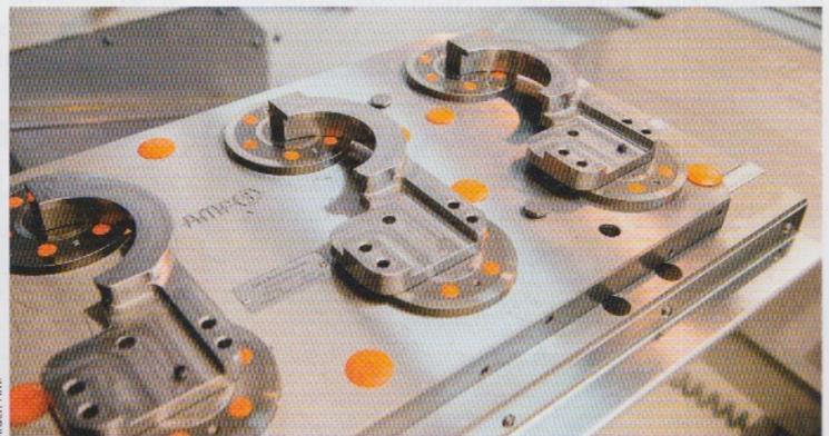
Eine Schlüsselstelle bei Labom ist der Vorrichtungs- und Werkzeugbau. Hier werden vorhandene Baugruppen mit kundenspezifischen Applikationen verbunden.
