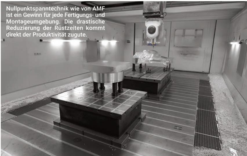
Nullpunktspanntechnik wie von AMF ist ein Gewinn für jede Fertigungs- und Montageumgebung. Die drastische Reduzierung der Rüstzeiten kommt direkt der Produktivität zugute.
