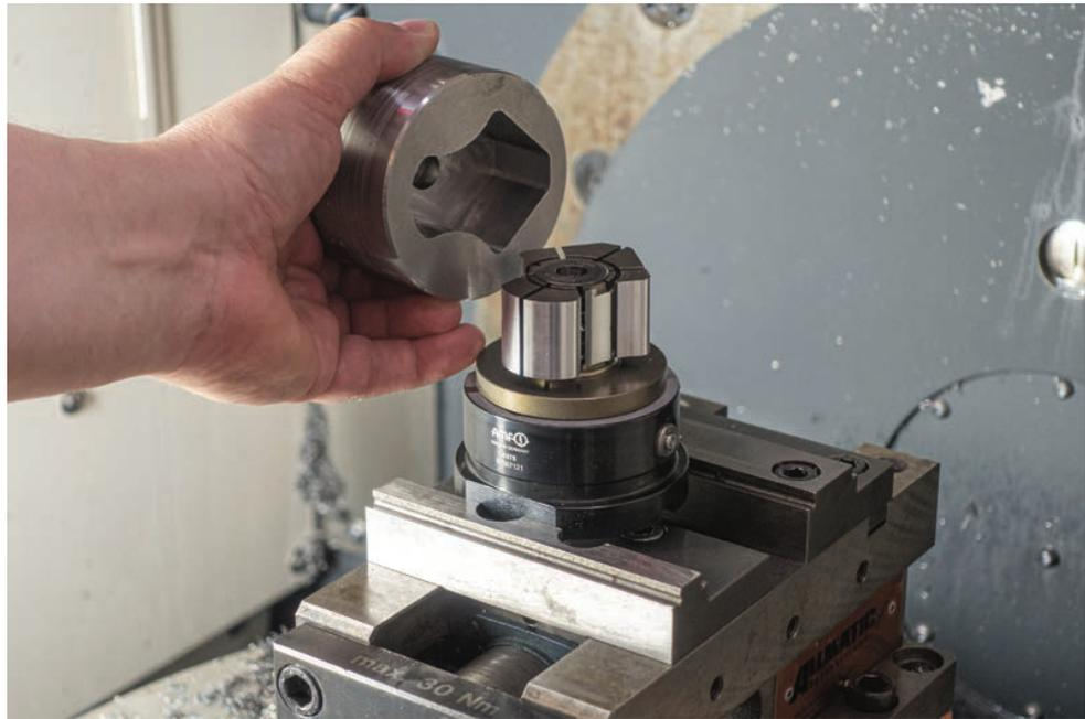
Auf der Fachmesse AMB 2022 zu sehen: Die neue Spannzange für das Innenspannen von AMF können Anwender an die Innenkontur ihrer Werkstücke anpassen.
