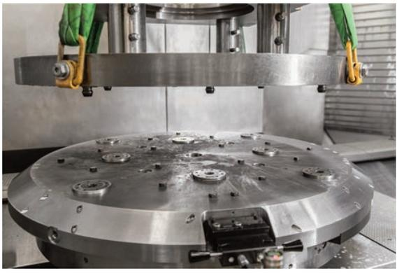
Acht AMF-Nullpunktspanmodule sind in einer Zwischenplatte eingelassen, auf der die Grundplatte für die Werkstückspannung aufsetzt.
