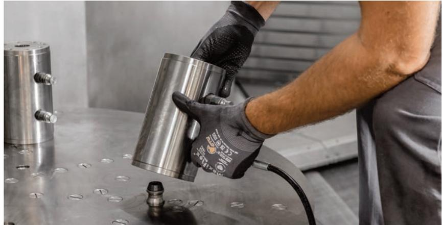
Mit beidseitig bestückten AMF-Nullpunktspannmodulen schaffen Spannkonsole die nötige Distanz zur Grundplatte für eine 5-Seiten-Bearbeitung.
