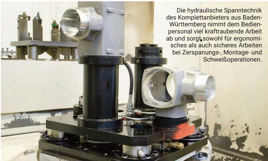
Die hydraulische Spann-technik des Komplettanbieters aus Baden-Württemberg nimmt dem Bedienpersonal viel kraftraubende Arbeit ab und sorgt, sowohl für ergonomisches als auch sicheres Arbeiten bei Zerspanungs-, Montage- und Schweißoperationen.
