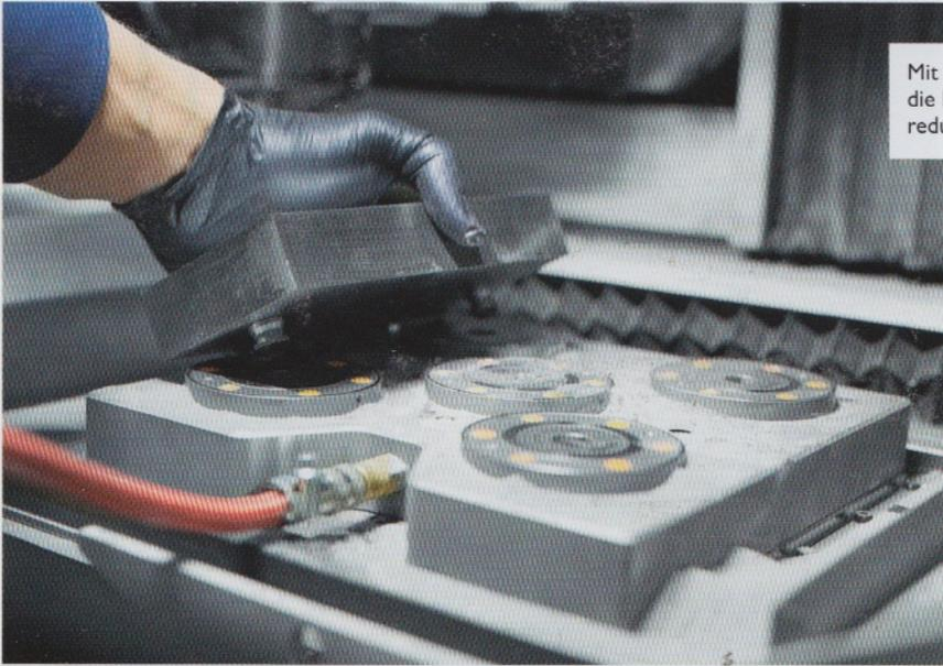
Mit dem AMF Zero-Point System kann die Rüstzeit auf ein Zehntel der Zeit reduziert werden.
