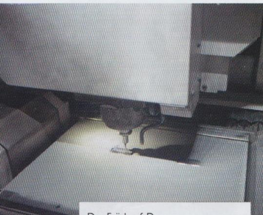
Der Fräskopf: Dessen Hochleistungsspindel beschleunigt den Fräser auf bis 45.000 U/min.
