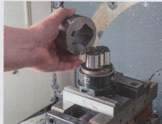
AMF zeigt auf der Messe AMB eine neue Spannzange für das Innenspannen. Die können Anwender an die Innenkontur ihrer Werkstücke anpassen.
