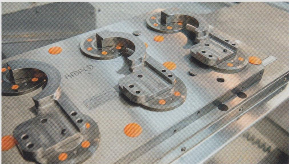
1 Die Spannstation von AMF bei Labom mit acht eingebauten Nullpunktspannmodulen ist mit 36 mm Gesamthöhe extrem flach (© AMF)
