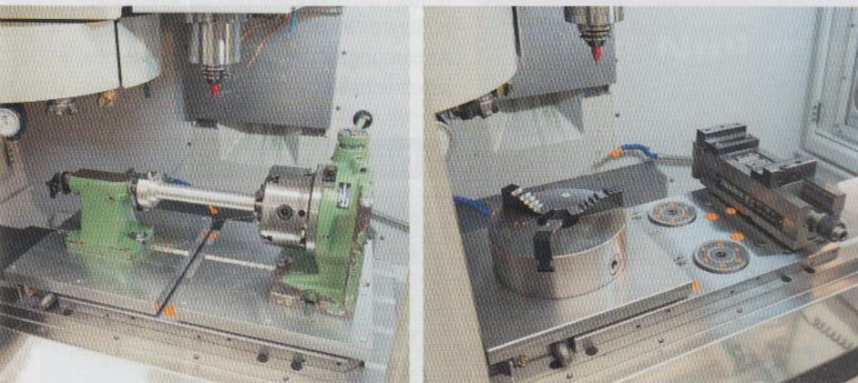
2 Enorm flexibel: Diverse Vorrichtungen zum Drehen (links) oder auch ein Spannstock (rechts) lassen sich kombiniert adaptieren (© AMF)
