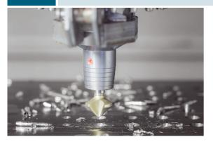
Dass Kegelsenker von Mapal kaum vibrieren und sie somit besonders genau arbeiten, lässt den Bedarf an ihnen steigen, heißt es in Aalen © Mapal
