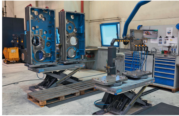
3 Rüstplatz mit höhenverstellbaren Scherentischen zur ergonomischen Bestückung der Paletten © AMF
