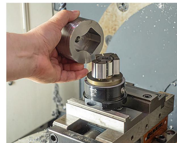
Die neue Spannzange von AMF für das Innenspannen kann auch Werkstücke mit einem Sackloch fixieren und passt sich der Innenkontur des Teils an © AMF
