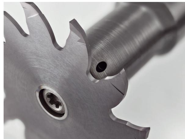
2 Das neue Werkzeugsystem Minimill XL ermöglicht ab einem Durchmesser von 50 mm und bei einem Breitenspektrum von 0,5 bis 6 mm eine Frästiefe bis zu 16,5 mm © Dümmel
