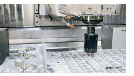
ür den vollautomatischen Werkstückwechsel während des Bearbeitungsprozesses entwickelte die Andreas Maier GmbH & Co. KG, kurz: AMF, ein Greifsystem mit einstellbaren Kräften. Das neue Greifsystem für Werkzeugmaschinen hat eine Schaftschnittstelle und wird wie ein Werkzeug aus dem Magazin eingewechselt. Für die Neuentwicklung stehen Greiferbacken für unterschiedliche Geometrien und verschiedene Werkstückgewichte zur Verfügung.
