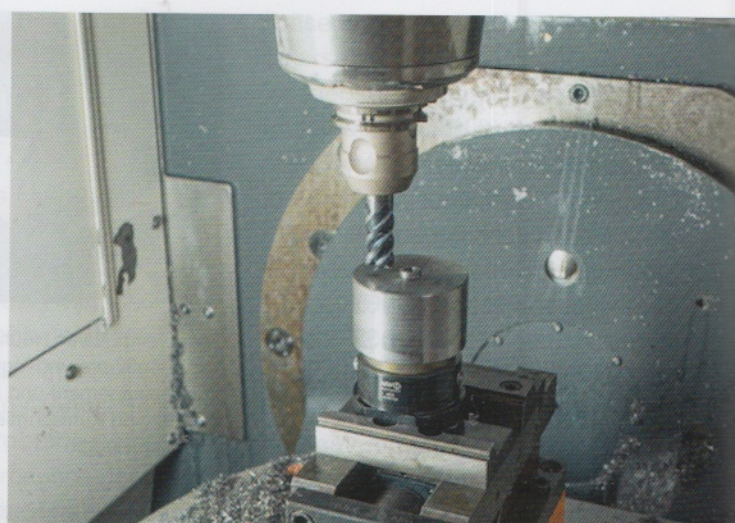
Bild 2: Durch die mechanische seitliche Betätigung können auch Werkstücke mit einem Sackloch sicher und verzugsfrei gespannt werden
