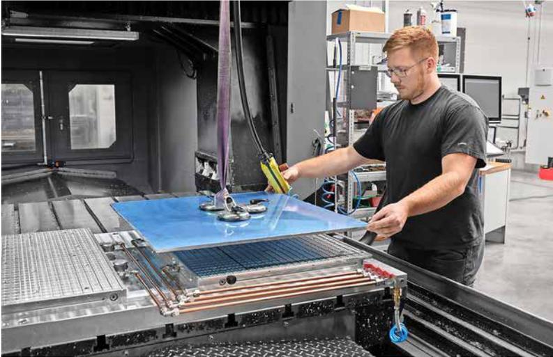
Auf der Oberseite hat die 40 mm hohe Vakuumspannplatte Nuten und 16 Ansaugstellen. Bohrungen für Anschlagstifte oder seitliche, höhenverstellbare Exzenteranschlänge positionieren Werkstücke einfach.
