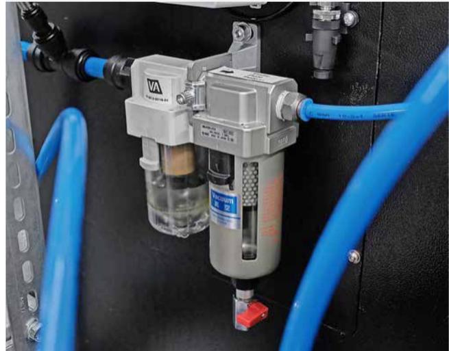
Das Vakuum-Filtersystem mit Flüssigkeitsabscheider und mit einem Druckwächter mit Sensor ist extrem feinfühlig.
