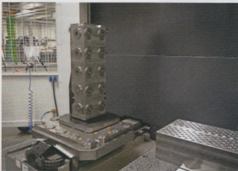
Mit 30 KH20-Modulen bestückte Spanntürme, die sich auf ebenfalls mit Nullpunktspannmodulen bestückten Grundplatten flexibel aufsetzen lassen kann auch horizontal gespannt werden.
