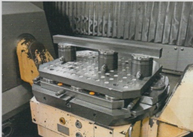
Obwohl AMF-Nullpunktspannmodule große Kräfte aufbringen, bauen sie nicht sehr hoch.
