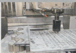
Das neue Greifsystem hat eine Schaftschnittstelle und wird wie ein Werkzeug eingewechselt. Anwender realisieren damit vollautomatische Werkstückwechsel auf einer Werkzeugmaschine.
