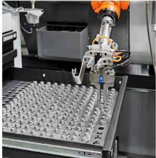
*Im Werkstückwagen lassen sich bis zu 2.000 Roh- und Fertigteile bevorraten.*
