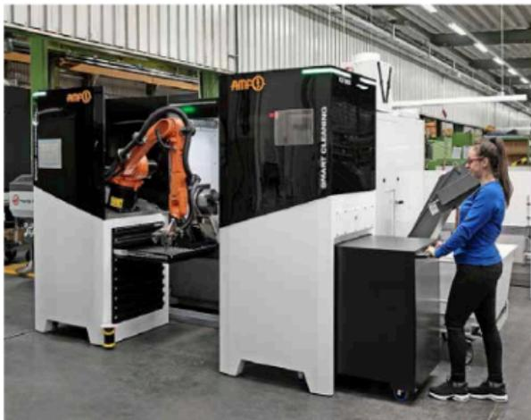
*Eingeschoben wird der Werkstückwagen von hinten. Weil er auf Schwerlastrollen steht, lässt er sich bequem ein- und ausfahren. So gelingt die Bestückung der Schubladen extern und hauptzeitparallel.*
