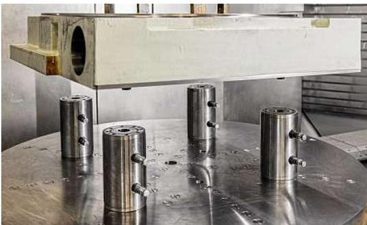
Mit AMF-Nullpunkt-Spannmodulen ist das Werkstück bei Fibro RT nun in drei bis vier Minuten gespannt, was früher mit Spanneisen, Distanzstücken und Verschraubung 30 bis 90 Minuten dauerte.
