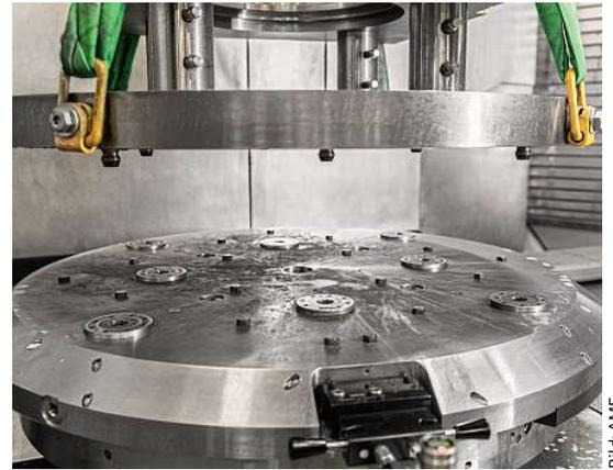
Acht AMF-Nullpunkt-Spannmodule sind in einer Zwischenplatte eingelassen, auf der die Grundplatte für die Werkstückspannung aufsetzt.
