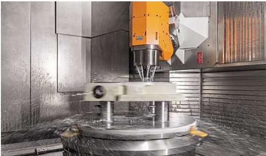
AMF-Nullpunkt-Spannmodule und weitere Maßnahmen ertüchtigen ein Dreh-Fräszentrum für die Komplettbearbeitung der Fibro-RT-Rundtische in einer Aufspannung.
