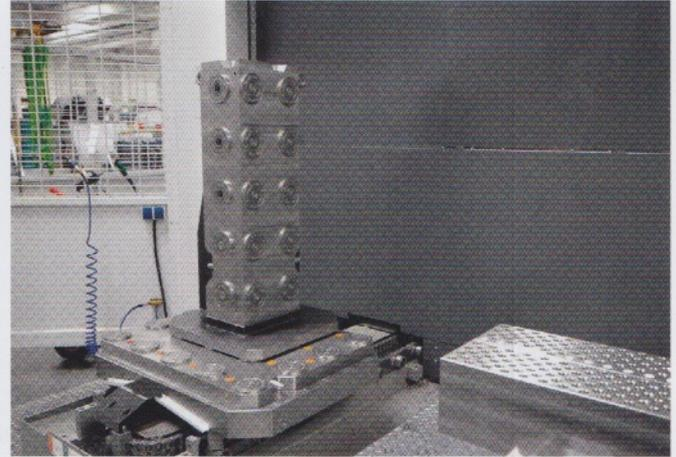
Mit 30 Modulen bestückte Spanntürme, die sich auf ebenfalls mit Nullpunktspannmodulen bestückten Grundplatten flexibel aufsetzen lassen, kann auch horizontal gespannt werden (Bild: AMF)
