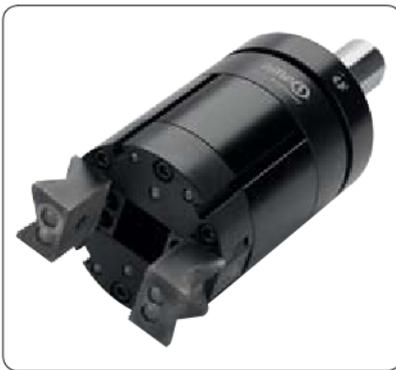
schienenlaufzeiten und die mannlose Bearbeitung, auch in zusätzlichen Schichten. Mit drei verschiedenen Greifeinsätzen – Finger, Prisma und Universal – können unterschiedliche Geometrien sicher gegriffen werden. Die prismenförmigen Greifeinsätze sind drehbar für noch mehr Flexibilität. Betätigt wird der Greifer über die Maschinenspindel,
