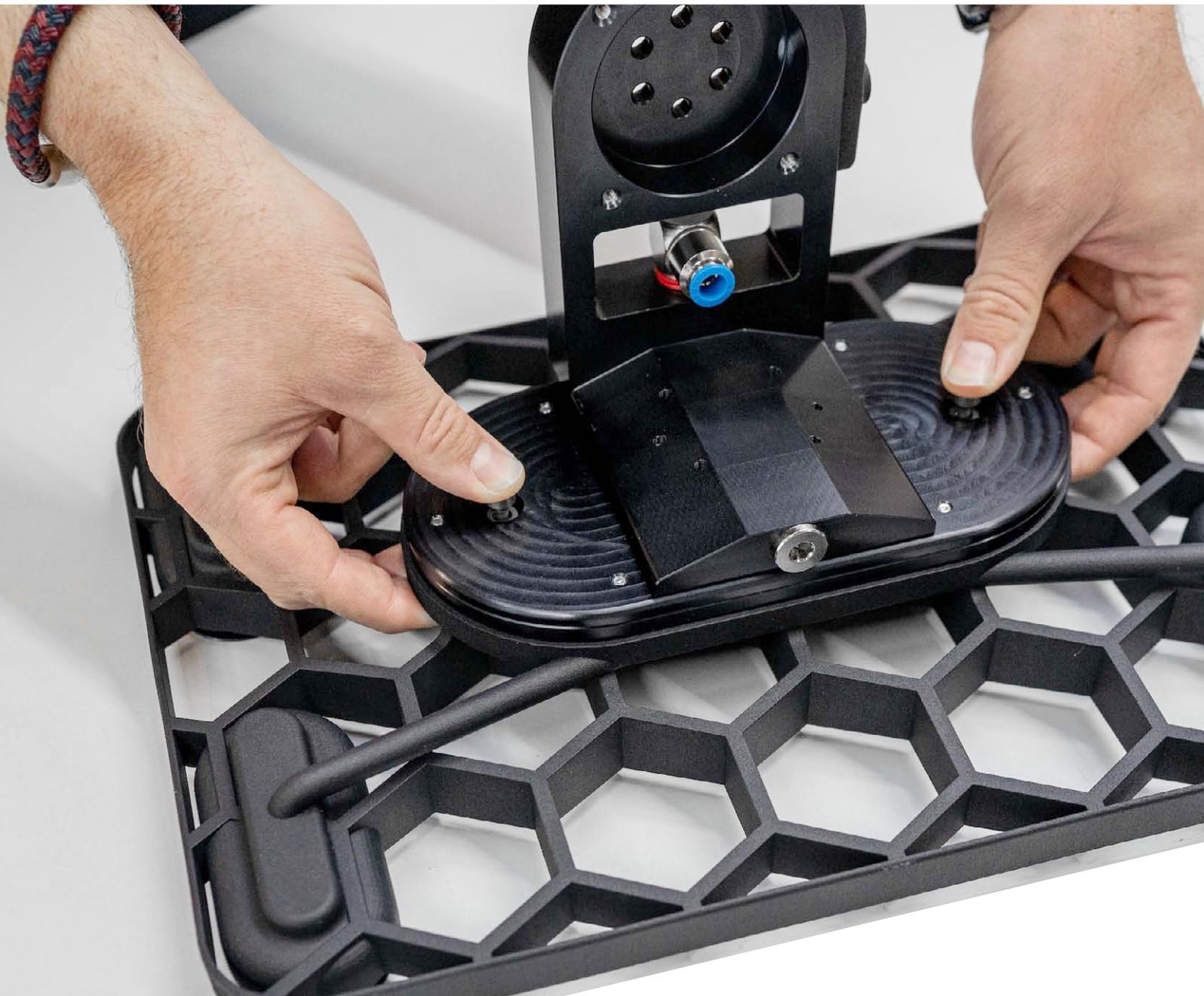
Die mechanischen Nullpunktspannmodule RM251 mit Rastfunktion lassen sich werkzeuglos mit einem Daumendruck öffnen und wieder verschließen.
