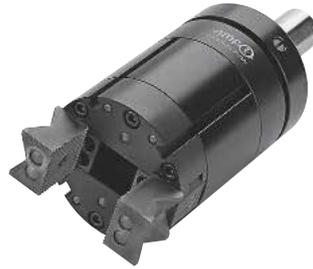
von 250 N bis 1000 N in der hydraulischen Version und zwischen 200 N und 700 N bei pneumatischer Ansteuerung. Darüber hinaus verfügt der Greifer über ein Ausgleichspiel für die C-Achse von  $\pm 3^\circ$  und für die Z-Achse von 5 mm, wodurch auch ungefähre Geometrien und Positionen gegriffen werden können. Der Hersteller bietet den Greifer mit zwei unterschiedlichen Trägern an, die Werkstücke von bis zu 70 mm transportieren können. ●
