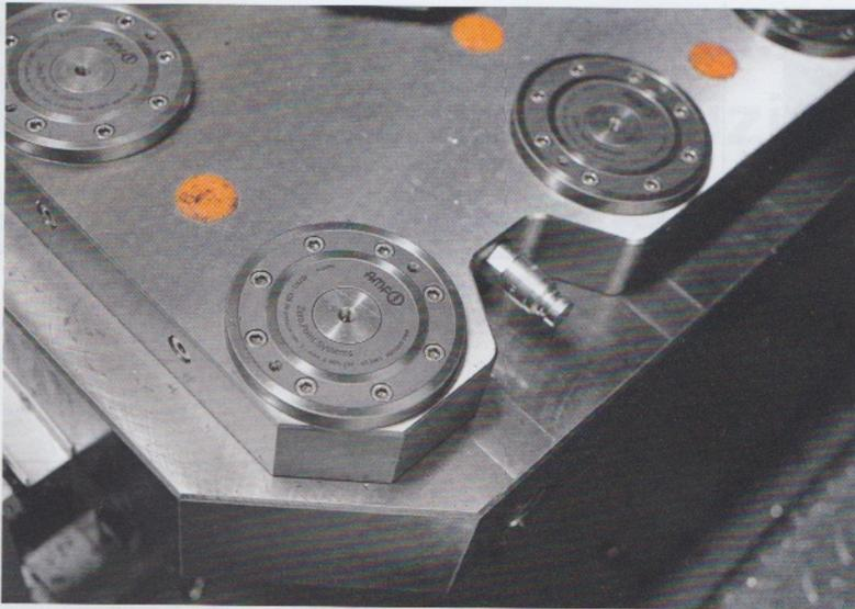
Bei den Rüstzeiten leistet umfangreiche Werkstückspanntechnik von AMF rund um starke und flache Nullpunktspannmodule einen wichtigen Beitrag
