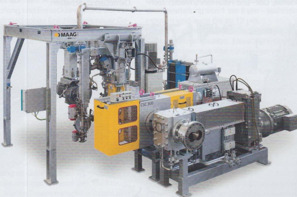
MAAG Komplett-system aus Schmelzpumpe, Siebwechslern und Unterwassergranulierung. Die Lochplatte ist das Kernstück des Granulators und mit allerhöchster Präzision gefertigt (Bild: MAAG)
