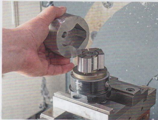
AMF zeigt auf der Messe AMB eine neue Spannzange für das Innenspannen. Den Spannzangenaufsatz können Anwender an die Innenkontur ihrer Werkstücke anpassen
