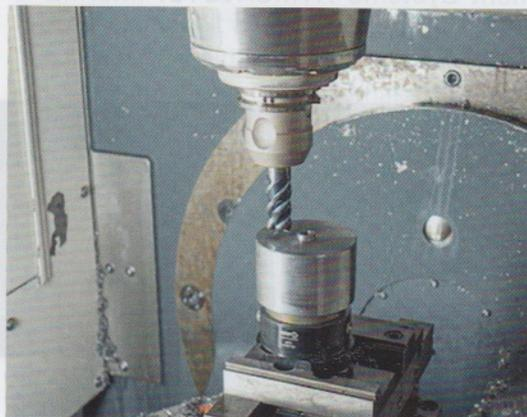
Durch die mechanische seitliche Betätigung können auch Werkstücke mit einem Sackloch sicher und verzugsfrei gespannt werden (Bilder: AMF)
