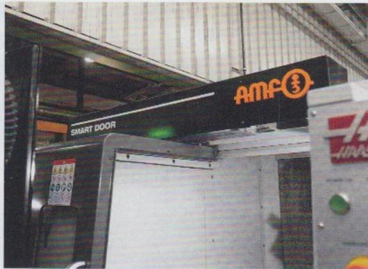
Zyklus ein fertig bearbeitetes Teil entnehmen und ein neues Rohteil einwechseln. Eine optionale Wende- und Positioniereinheit ermöglicht die präzise Bearbeitung von Teilen an allen Seiten.
