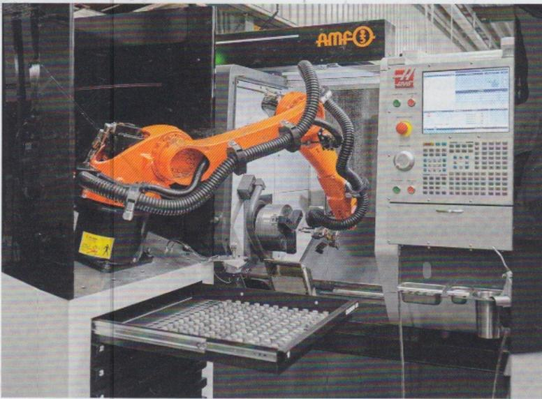
Das neue, flexible Roboter-Beladesystem Smart Automation von AMF automatisiert das Werkstückhandling an Drehmaschinen und Bearbeitungszentren
