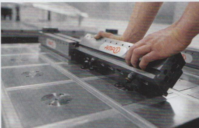
Bild 6: Das Nullpunktspannsystem von AMF ist so einfach und logisch wie Lego. Alles passt zueinander und lässt sich schnell und passgenau platzieren
