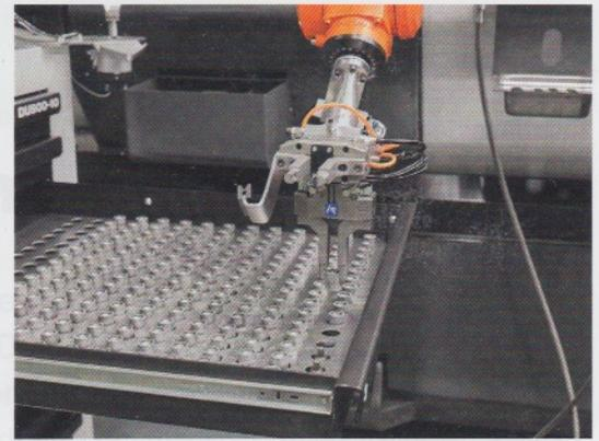
In den Werkstückwagen platziert Güthle gleichermaßen bis zu 2.000 Roh- und Fertigteile der Kugelpfannen aus Werkzeugstahl
