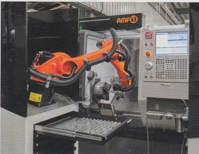
wichtigen Teile stellen sie nun in Ebersbach an der Fils nahe Stuttgart selbst her, anstatt sie weiterhin zuzukaufen. Bis zu 10.000 Stück der Metallpressteile werden jährlich in vier Varianten auf Maß gedreht. Beladen und entnommen werden die Werkstücke vom Roboter. Dazu öffnet und schließt Smart Door die Türe zur Drehmaschine automatisch, bevor die Werkstücke in der gegenüber positionierten Reinigungsanlage Smart Cleaning gesäubert werden und dann zum Härten gehen.
