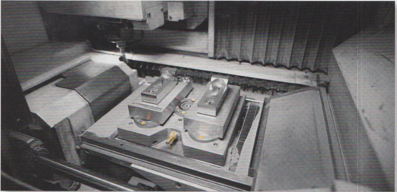
Bild 1: Mit dem Nullpunktspannsystem Zero-Point von AMF lassen sich Rüstzeiten um bis zu 90 Prozent reduzieren
