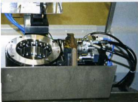
Im Lademodul setzt ein Greifer die Werkstücke in das Hydrodehnspannfutter ein, das einen Öffnungswinkel von 0,2 mm hat
