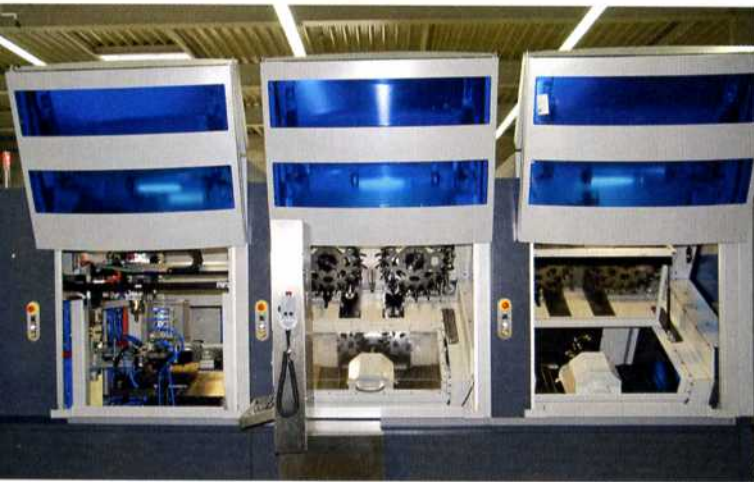
Modulares Bearbeitungssystem Multistep XT-200 von Mikron
