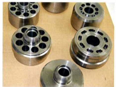
Werkstücke aus Aluminium und GGG 60 Sphäroguss werden mit einer einzigen Aufspannung sicher durch die Anlage geführt
