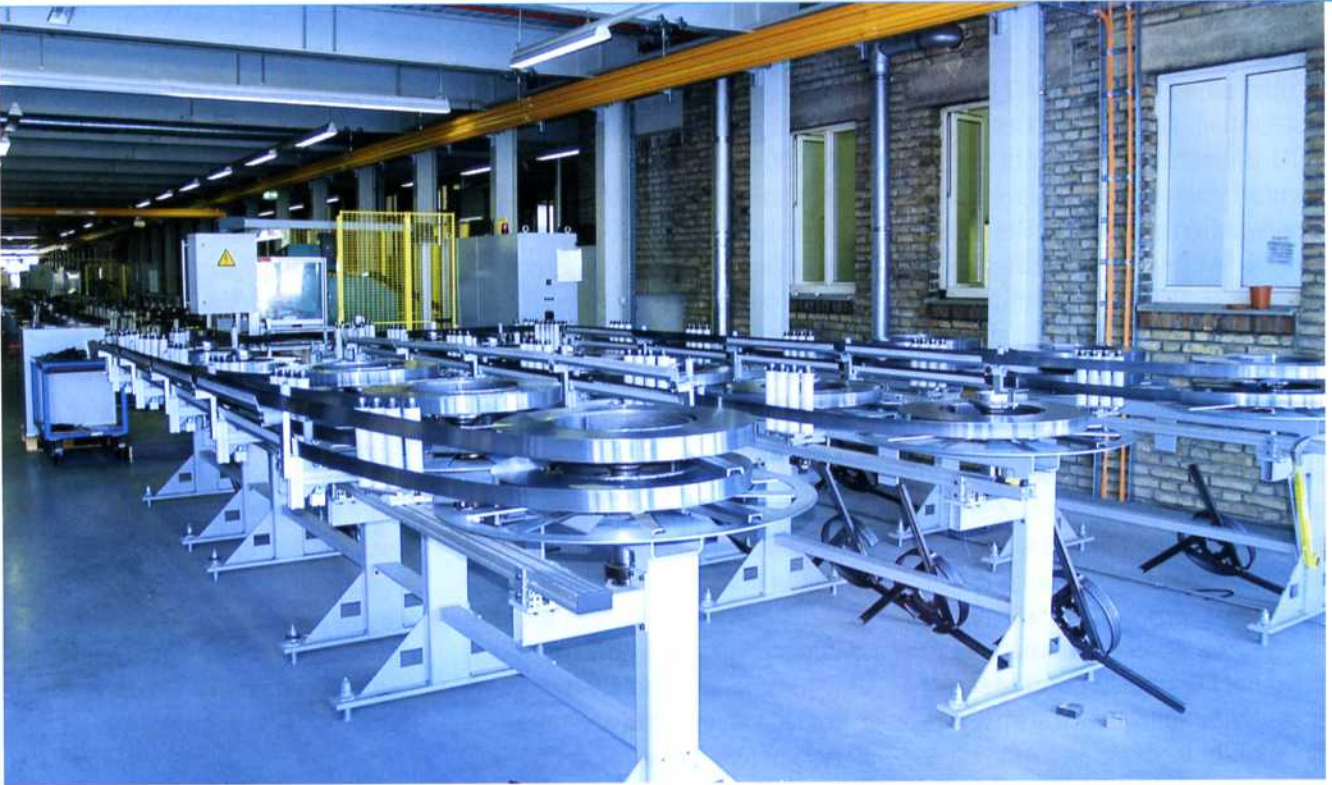
Bild 1: Bei Eberle kommen Spezialhaspelanlagen der Georg Kesel GmbH & Co. KG in horizontaler Ausführung zum Einsatz
