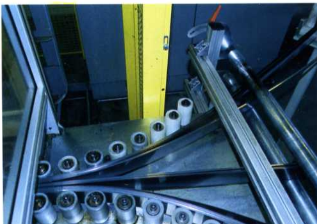
Bild 2: Bis zu 40 Bänder mit je bis zu 800 Millimeter Außendurchmesser werden von den Haspeln abgewickelt, zusammengeführt, geklemmt und taktgenau der Fräsmaschine zugeführt
