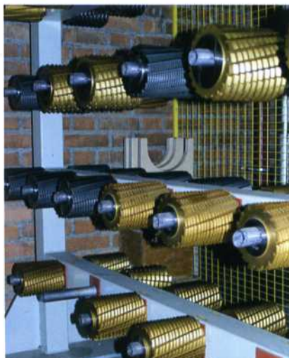
Bild 8: Durch ein Schnellwechselsystem lassen sich die Fräswerkzeuge schnell und bequem für die Herstellung entsprechender Zahnteilungen und Zahngeometrien umrüsten
