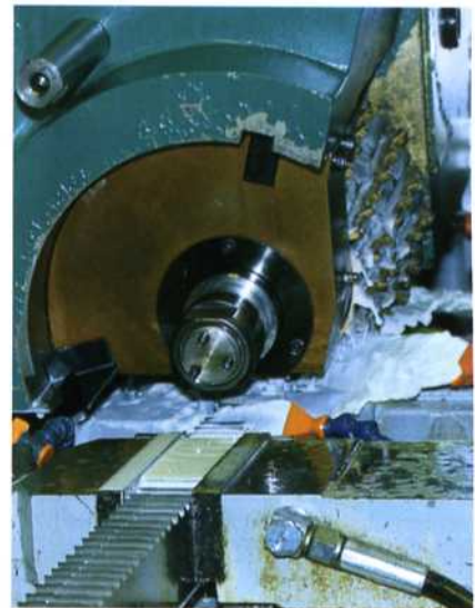
Bild 4: Das bis zu 200 Millimeter breite Fräs-werkzeug kann einen Durchmesser zwischen 128 Millimeter plus zweimal Frästiefe und maximal 250 Millimeter haben. Mit 15 bis 315 Umdrehungen pro Minute und einem Verzahnungsbereich von 32 bis 0,75 TPI lassen sich in Bandbreiten von 6 - 100 mm Sägezähne in unterschiedlicher Teilung fräsen
