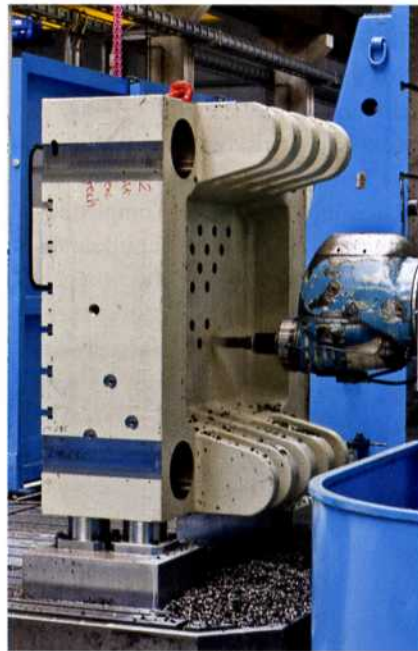
2 Sicheres Spannen trotz ungünstiger Hebelverhältnisse: Zero-Point-Nullpunktspannsystem von AMF
