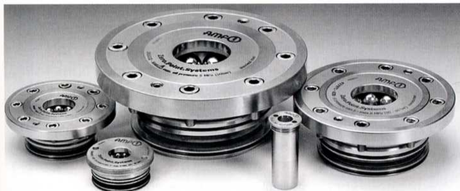
Nullpunktspannsysteme ermöglichen das automatisierte Spannen mit Wiederholgenauigkeiten < 5 \mu\text{m} , in klimatisierten Räumen sogar < 3 \mu\text{m}
