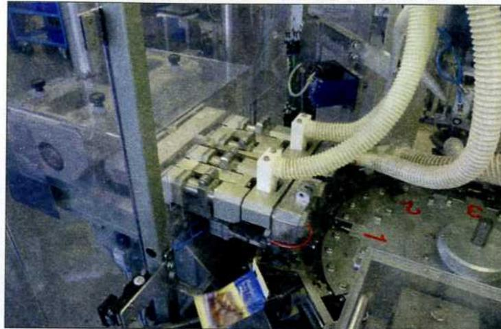
Das nachgerüstete Ultraschall-Siegelmodul führt bei der Lebensmittelverpackung zu kurzen Schweiß- und Haltezeiten, einer hohen Nahtfestigkeit sowie niedrigen Ausschussquoten.
