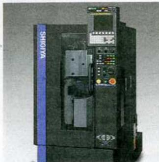
Durchmesser und Schulter schleifen soll. Die Maschine ist für Werkstücke mit einer Länge bis 150 mm und einem Durchmesser bis 30 mm ausgelegt. (vs)
