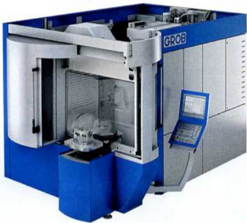
Das hydraulikfreie Bearbeitungszentrum der G-Baureihe ist mit einem elektromechanischen Palettenwechsler ausgestattet Bild: Grob
