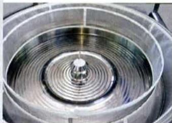
Dieser Trommel-Coater zeichnet sich durch ein vollkommen geschlossenes, von der Umwelt und Arbeitsumgebung abgekoppeltes Prozessluft-Kreislaufsystem mit integrierter Stoff- u. Energie-Rückgewinnung aus. Damit wird ein hoher Freiheitsgrad bei der Aufstellung solcher Anlagen ermöglicht und gleichzeitig höchste Sicherheitsstandards
