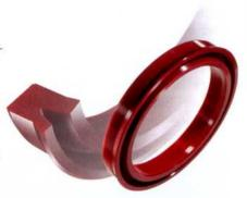
einen Werkstoff mit hoher Verschleiß- und Reißfestigkeit und niedrigem Druckverformungsrest, der gegenüber Mineralölen und einer Vielzahl weiterer Medien wie HFA, HFB, HFDU, HETG und HEES, Alkoholen wie bspw. Ethanol, Scharnierstoffen und Ölen auf Silikonbasis sowie biologisch abbaubaren Druckflüssigkeiten resistent ist.
