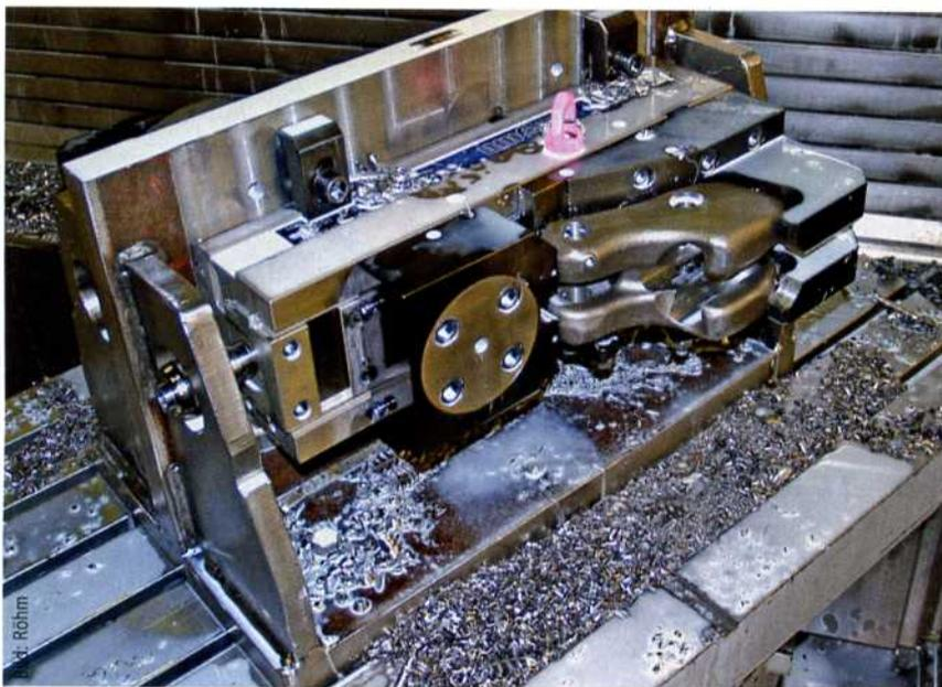
Mit der Aufspannvorrichtung von Röhм hat sich für RUD die reine Bearbeitungszeit eines Werkstückes von 54 auf 36 Minuten (um 33 %) reduziert.
