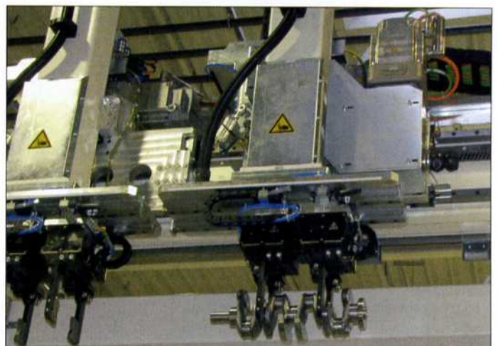
Die Greifer sind auf einer Grundplatte montiert, die auch die NC-Technik für das Drehen und Verfahren beherbergt. Eine Lösung, die Röhm und der Anlagenbauer gemeinsam entwickelt haben.
